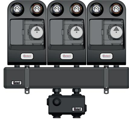
**Entschlammung und Entlüftung.** Aufgrund der Form des Gehäuses kann die hydraulische Weiche auch eine Schlammsammel- und Entwässerungsstelle an der Unterseite sowie eine Sammelstelle für Mikroluftblasen bieten, die durch eine optionale Entlüftung an der Oberseite abgeführt werden können.
