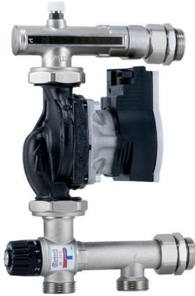
Groupe pré-assemblé pour la régulation et la circulation du fluide mélangé à point fixe. Assure la circulation du fluide caloporteur provenant du circuit primaire et maintient la température définie (point fixe) sur une valeur constante à travers une vanne mélangeuse à élément thermostatique. Il est traditionnellement utilisé dans les installations de chauffage et dans les installations à panneaux rayonnants.
