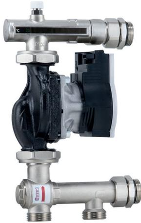
Grupo preensamblado para la distribución o circulación directa. Permite la circulación del fluido caloportador procedente del circuito primario, sin realizar regulaciones térmicas. Se utiliza en situaciones en las que la temperatura de ida del circuito primario es igual a la requerida por los puntos de uso en los sistemas de calefacción/refrigeración en general y en los sistemas de paneles radiantes.
