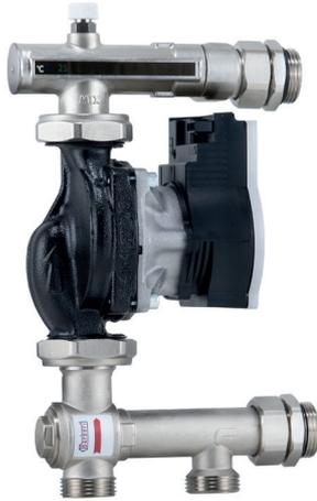
Vormontierte Einheit für die direkte Verteilung oder Zirkulation. Ermöglicht das Zirkulieren des Mediums im Wärmeträger aus dem Primärkreislauf, ohne thermische Anpassungen vorzunehmen. Sie wird in Situationen eingesetzt, in denen die Vorlauftemperatur des Primärkreislaufs gleich der vom Nutzer allgemein in Heiz-/Kühlsystemen und Flächenheizungen geforderten ist.
