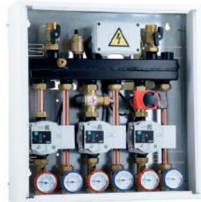
O kit pré-montado composto por caixa, coletor com separador hidráulico extraível, caixa elétrica pré-cablada, 2 ou 3 grupos DN 20 à escolha entre: distribuição direta 71G.DN20, regulação termostática 72G.DN20, motorizado em 3 pontos 73G.DN20. Isolamento opcional 43D.02.
